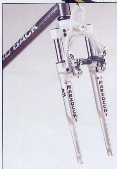
Marzocchi XC-200 Hydraulic Suspension
