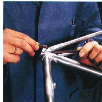
Op de Gazelle race-afdeling worden de frames met de hand op maat gebouwd.
