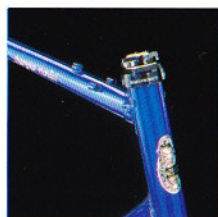
Bij het cross-frame worden alle kabels over de bovenbuis geleid.
