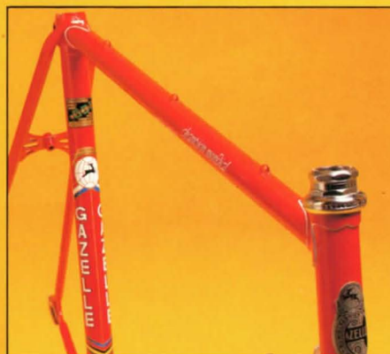
Bremskabelführungen auf dem Oberrohr
