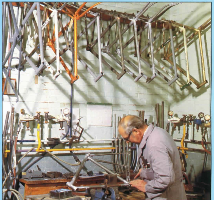
Der gelötete Rahmen wird bis ins kleinste Detail nachgearbeitet und überprüft.
