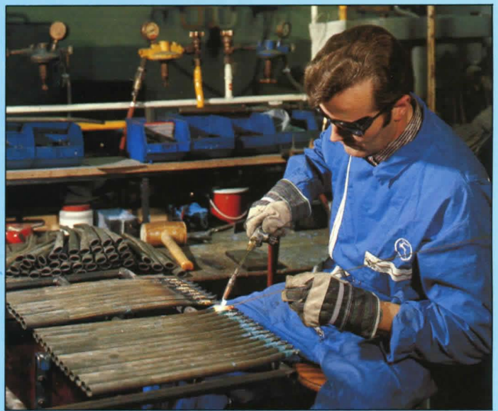
Das Lötten der Vorderradausfallenden.
