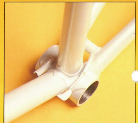
Kabelführungen auf dem Tretlagergehäuse
