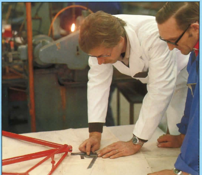
Der gelötete Rahmen wird bis ins kleinste Detail nachgearbeitet und überprüft.
