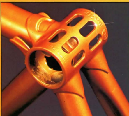
Ausgebohrtes Tretlagergehäuse (nur möglich bei Reynolds 753 und 531 SL Rahmen)
