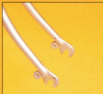
Verchromte Klemmränder an den Ausfallenden der Vorderradgabel.
