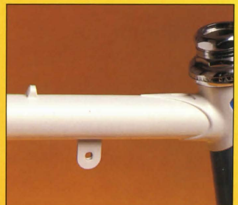
Fotofinishplatte (nur möglich bei AB-Rahmen und bei Reynolds 753 und 531 SL Rahmen)
