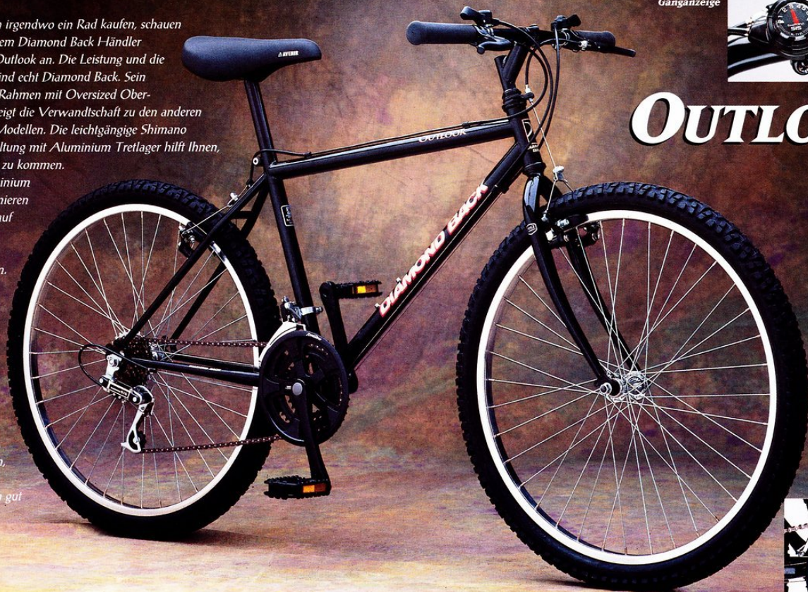
SR Aluminiumkurbel mit Dreifachkettenblatt
