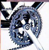
Alivio Kurbeln mit Hyperdrive - C Zahnkränzen für exakteres Schalten
