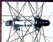
Shimano Alivio Parallax Naben mit Schnellspannern
