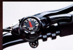
Shimano Schalthebel mit optischer Ganganzeige
