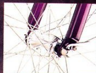
Aluminium Vorderradnabe mit Schnellspanner
