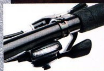
Alivio Rapidfire Plus Schalthebel mit optischer Ganganzeige
