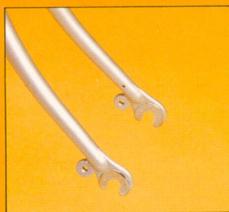
Verchromde padklemranden op de voorvork.
