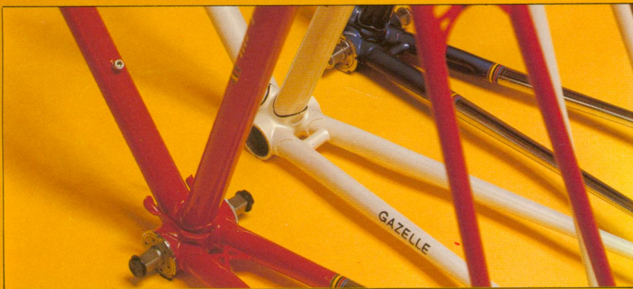
Achternvorken in diverse detailuitvoeringen. Van onder naar boven: het AA frame, het baanframe en het A frame.
