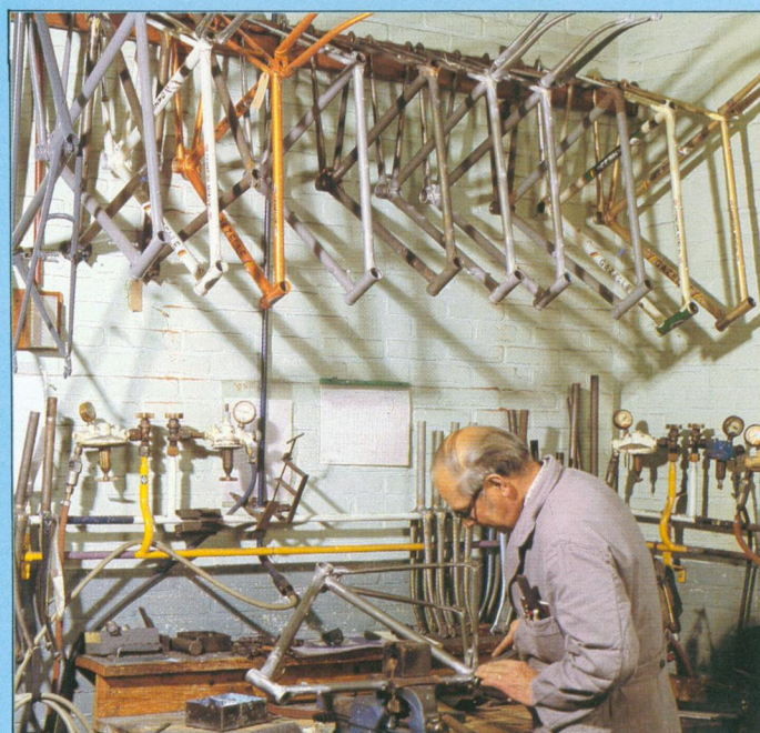
Het gesoldeerde frame wordt tot in de kleinste details afgewerkt en gecontroleerd.
