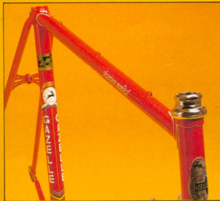
Remkabeloogjes op bovenbuis
