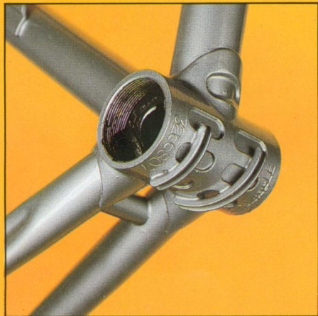
Kabelgeleiders onder de bracket.
