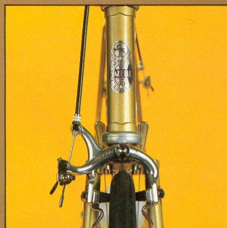
De Champion Mondial Race heeft een Sakae Royal stuurpen. Op de onderste foto het fameuze Gazelle-balhoofdplaatje en de Shimano 600 EX voorrem.
