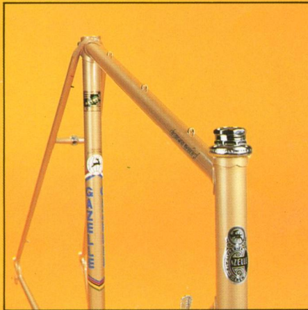
Remkabeloogjes op bovenbuis.
