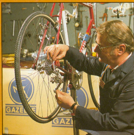
Het op maat maken van de kabel en het afstellen van de achterderailleur.
