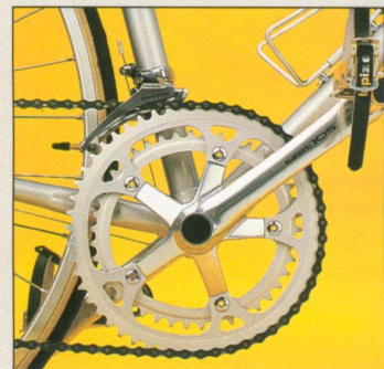
Shimano 'New 105' crankstel en voorderrailleur
