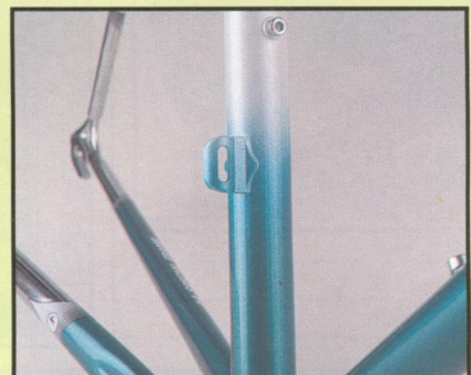
Aangesoldeerde nok voor derailleur op staande buis, optie bij Formula- en Champion Mondial A-frame
