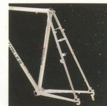
Brugstuk op staande achtervork voor rem- kabel. Dynamohaak op linker, staande achtervork.
