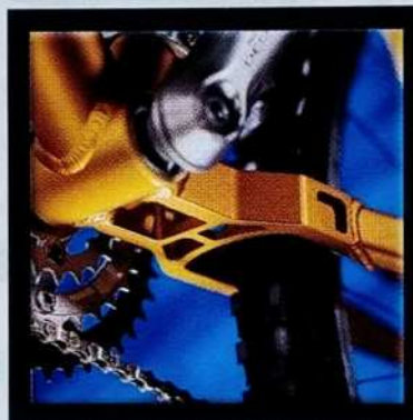
Einteilige, geschmiedete Verbindung zwischen Tretlagergehäuse und Kettenstreben
