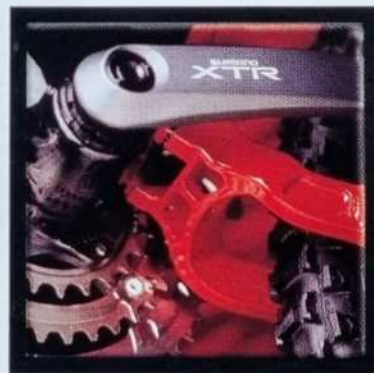
Einteilige, geschmiedete Verbindung zwischen Tretlagergehäuse und Kettenstreben
