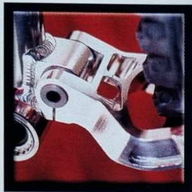
Einteilige, geschmiedete Verbindung zwischen Tretlagergehäuse und Kettenstreben
