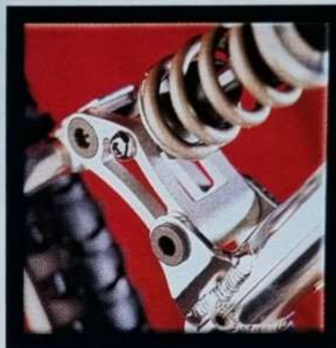
Hart anodisierte Aluminium Lager
