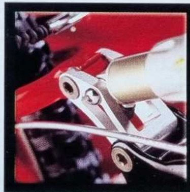
Hart anodisierte Aluminium Lager
