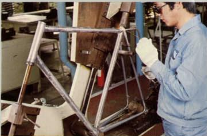
Door de beste specialisten van Miyata in Japan worden de frame's gesoldeerd. Ook dit gebeurt volgens de zogenaamde "koude" methode. Dit om de materiaalstructuur te handhaven, wat een grote sterkte van de verbindingen garandeert.
