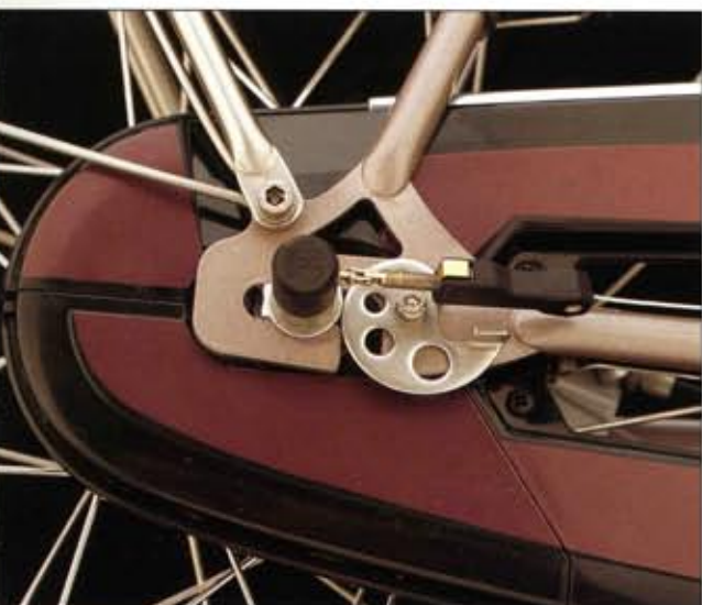
Koga-Miyata's achternorconstructie voor snelle montage en demontage van achterwiel en ketting spannen (RA/RAL).
