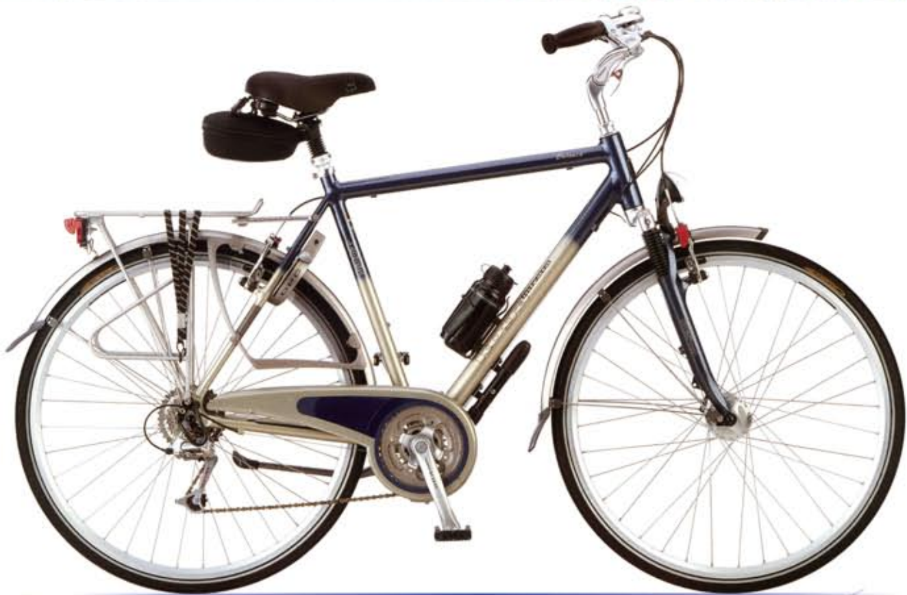
Balance (BL) Framematen 50-54-57-60-63cm Framemateriaal Aluminium 7005 Voorvork Insyric Odesa LX met lock-out, veerweg 45mm Kleurencombinatie Ocean blue metallic/ Champagne metallic Groep Shimano Nexave T300 Velgen Exal ZX19 622-19 36g Zilver "dubbel gebust" Zadelpen Post Moderne Solace comp ø26.8x270mm veerweg 35mm Pedalen Koga VP-191 met industriële lager Koplamp B&M Lumotec Topal senso automatisch incl. reflector Dynamo Shimano naafdynamo HB-NC30 6W/3.0W 36g 100mm Detailinformatie pagina 90
