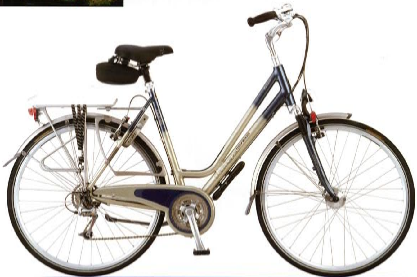
Balance (BLL) Framematen 47-50-53-56cm Framemateriaal Aluminium 7005 Voorvork Insyne Odesa LX met lock-out, veerweg 45mm Kleurencombinatie Ocean blue metallic/Champagne metallic Groep Shimano Nexave T300 Velgen Exal ZX19 622-19 36g Zilver "dubbel gebust" Zadelpen Post Moderne Solace comp ø26,8x270mm veerweg 35mm Pedalen Koga VP-191 met industriële lager Koplamp B&M Lumotec Topal sensio automatisch incl. reflector Dynamo Shimano naafdynamo HB-NX30 6V/3,0W 36g 100mm Detailinformatie pagina 90
