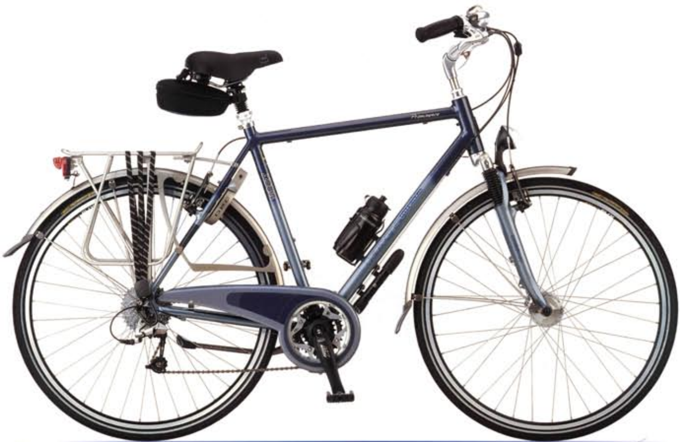
Prominence (PR) Framematen 50-54-57-60-63cm Framemateriaal Aluminium 7005 Voorvork Insync Odesa LX met lock-out, veerweg 45mm Kleurencombinatie Solent blue metallic/ Cirrus blue metallic Groep Shimano Deore LX Banden Continental CityContact 37-622 Zadelpen Post Moderne Solace comp ø26,8x270mm veerweg 35mm Koplamp B&M Lumotec Total senso automatisch incl. reflector Dynamo Shimano naaldynamo HB-NX30 6W/3,0W 36g 100mm Achterdrager SL Bike Titan Detailinformatie pagina 89
