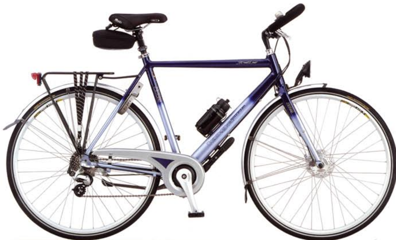
StreetLiner (ST) Framematen 50-54-57-60-63cm Framemateriaal Aluminium 7005 Voorvork Aluminium gekleurd Kleurencombinatie Dark blue/metallic/Light blue/metallic Groep Shimano Intego (IC530) Banden Continental SportContact 37-622 Zadel Selle Italia FLX Gents Leer Zadelpen Post Moderne Solace comp a31, 4x270mm veerweg 35mm Zwart Dynamo Shimano Nexus HB-NX50 6W/3,0W 36g 100mm Achterdrager Tubus LOGO light Detailinformatie pagina 82
