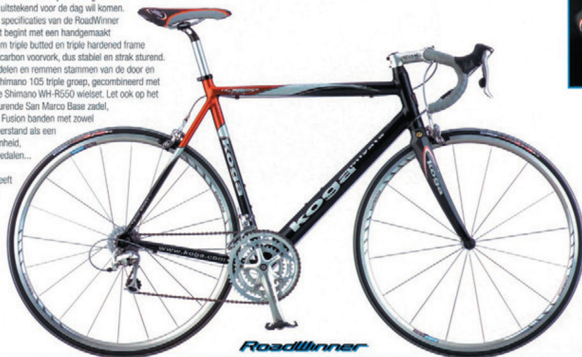
RoadWinner (RW) Framematen 50-54-56-58-60-63-66cm Framemateriaal Aluminium 7005 Voorvork The Sword carbon Kleurencombinatie Anthracite metallic/Copper orange metallic Groep Shimano 105 27-speed Stuurbocht ITM Lite Luxe Super Over ø31,8 Zwart Stuurvoorbouw ITM Forged Lite Luxe Super Over, ø31,8 Clamp diam. Zilver Wielset Shimano WH-R550 Zilver 16-20sp. Zadelpen ITM Luxe ø27,2x270mm Zilver Detailinformatie pagina 53
