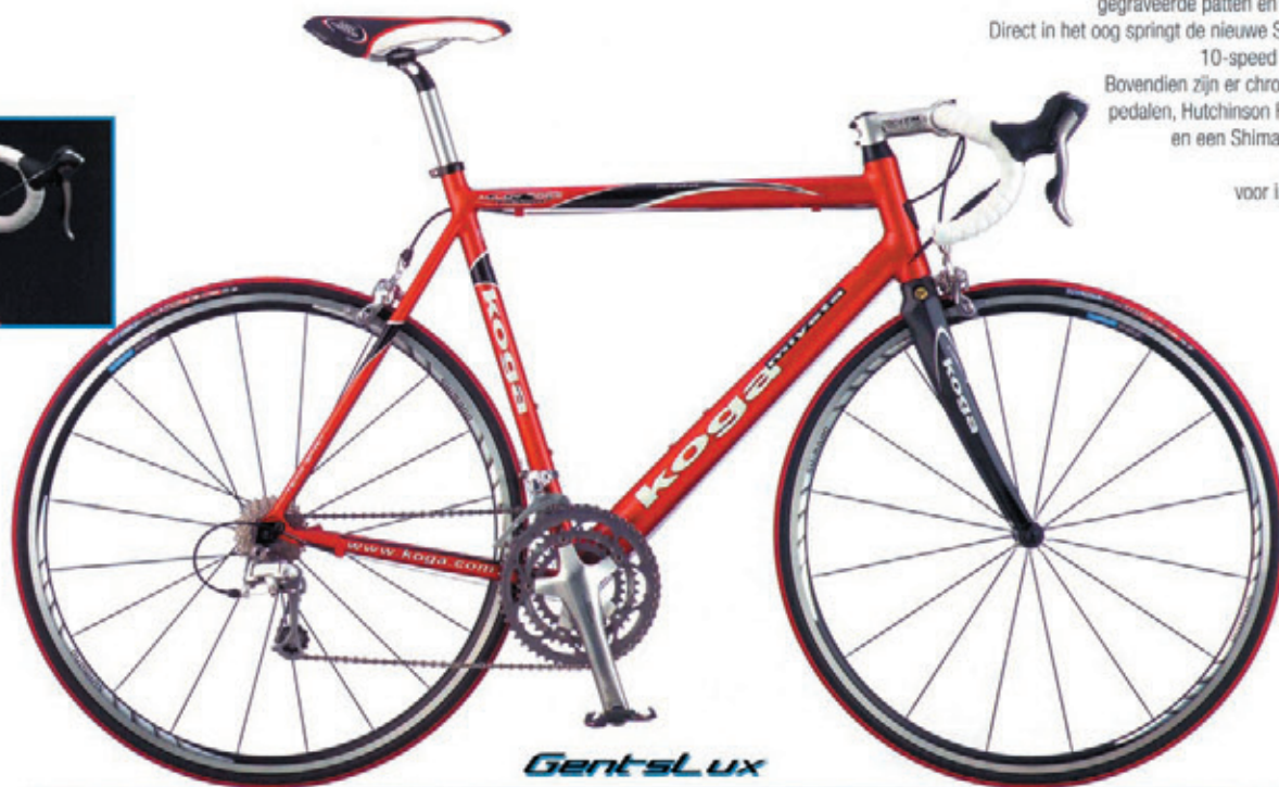
GentsLux (GSL) Framematen 52-54-56-58-60-63cm Framemateriaal Aluminium 7005 Voorvork The Sword carbon Kleurencombinatie Red metallic Groep Shimano Ultegra 30-speed Stuurbocht ITM Lite Luxe Super Over ø31,8 Zwart Stuurvoorbouw ITM Forged Lite Luxe Super Over, ø31,8 Clamp diam. Zilver Wielset Shimano WH-R550 Zwart 16-20sp. Zadelpen ITM Luxe ø27,2x270mm Zilver Detailinformatie pagina 53
