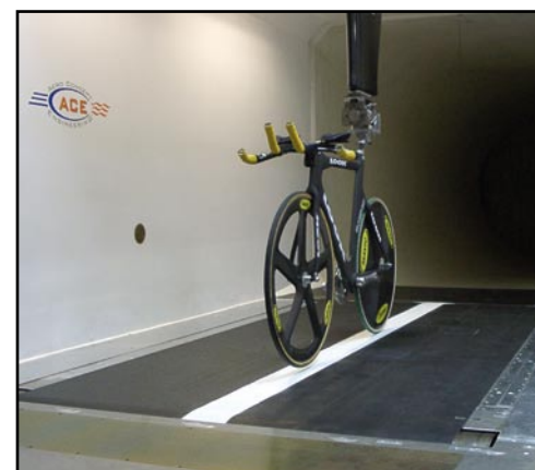
Dessins et photo du LOOK 496 lors des essais au centre de tests - soufflerie ACE du circuit de Formule 1 à Nevers - Magny-cours (France)
