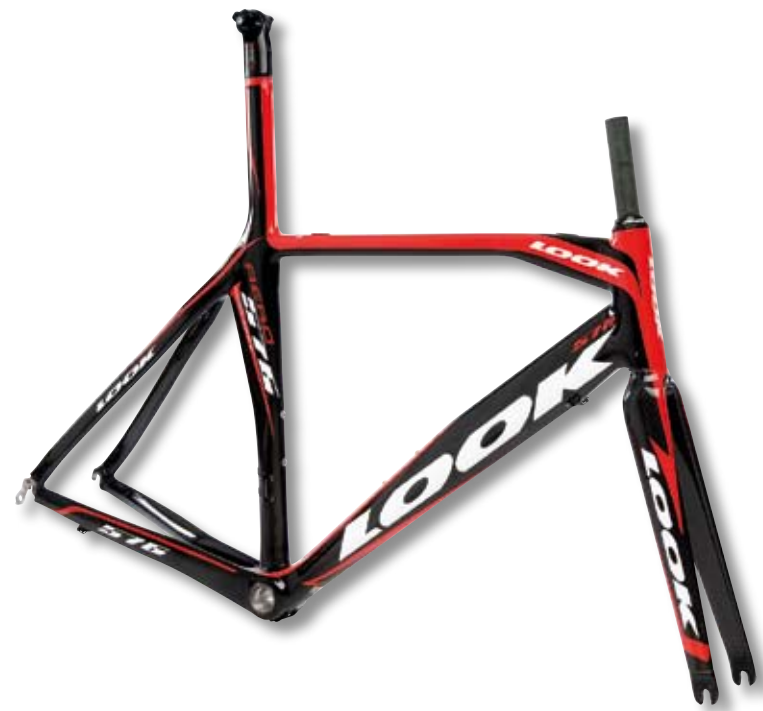
576 AERO RED TYPE CARBONE : HR HM MIX FOURCHE : AERO RACCORDS : SANS : CONSTRUCTION MONOBLOQUE TIGE DE SELLE : EPOST R 5 PATTES : ARRIÈRE DROITE REMPLAÇABLE EN ALUMINIUM POIDS CADRE : 1 100 GR. POIDS FOURCHE : 350 GR. AVEC JEU DE DIRECTION
