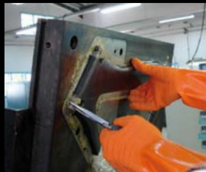
Extraction de la pièce monocoque en carbone
