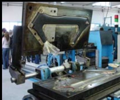
Ouverture d'un moule monocoque
