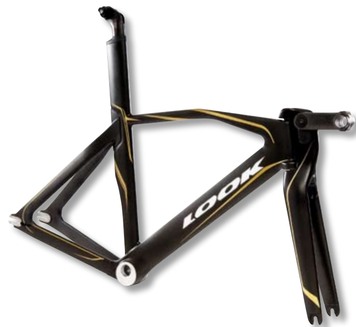
596 TRACK TYPE CARBONE : VHM (VERY HIGH MODULUS) FOURCHE : OFFSET AERO RACCORDS : SANS - CONSTRUCTION MONOBLOQUE TIGE DE SELLE : E-POST R32 INTEGRÉE PATTES : SPÉCIFIQUES PISTES POIDS CADRE : 1350 GR. (TAILLE S), TIGE DE SELLE NON COUPÉE POIDS FOURCHE : 450 GR. SANS JEU DE DIRECTION
