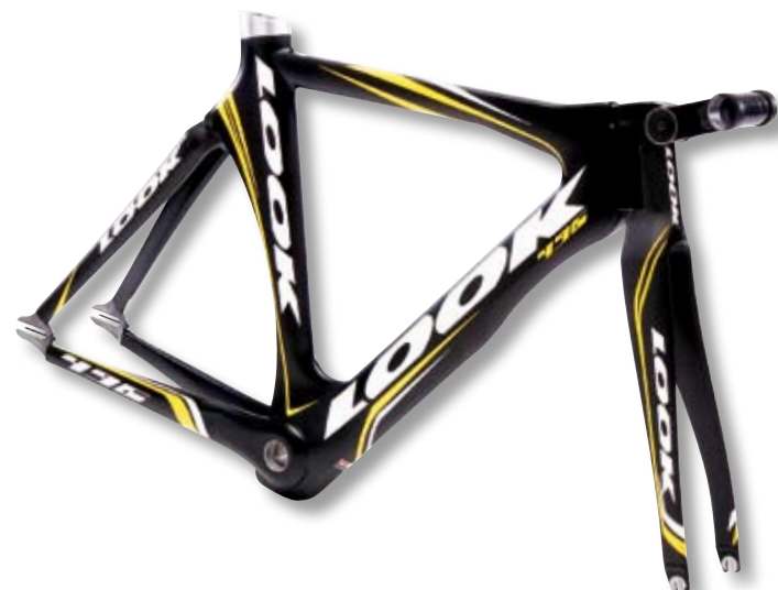
496 TRACK TYPE CARBONE : VHM FOURCHE : DÉPORTÉE RACCORDS : SANS - CONSTRUCTION MONOBLOQUE SERRAGE TIGE DE SELLE : COLIER SECTION ELLIPTIQUE, DÉPORTÉ POUR ANGLE DE SELLE 76° PATTES : SPÉCIFIQUES PISTE POIDS CADRE : 1700 GR. POIDS FOURCHE : 640 GR. AVEC JEU DE DIRECTION
