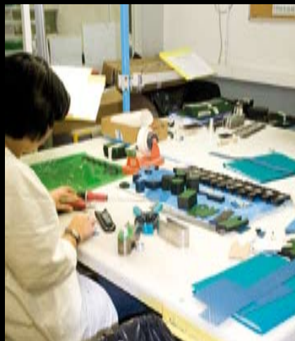
◀ Assemblage manuel de différentes pièces de carbone pour la réalisation d'une potence
