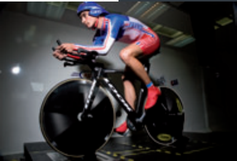
Mesure en soufflerie des valeurs aérodynamiques du 596.
