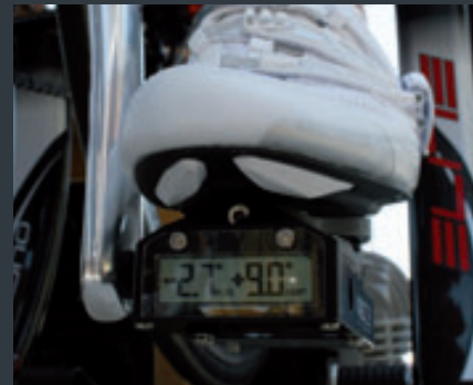
Mesure de l'amplitude du mouvement angulaire du pied gauche pendant le pédalage
