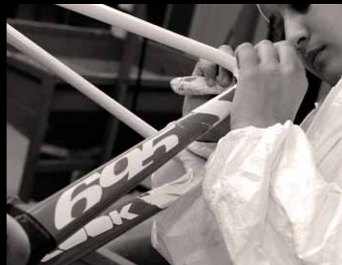
Composé de 430 pièces de carbone, Il faut une trentaine d'heures pour fabriquer le cadre 695.
