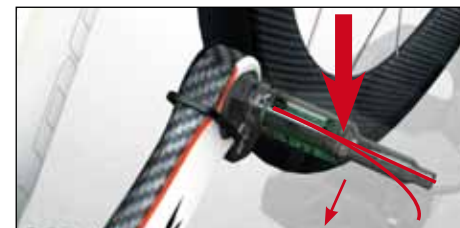
Les capteurs mesurent la déformation de l'axe de la pédale
