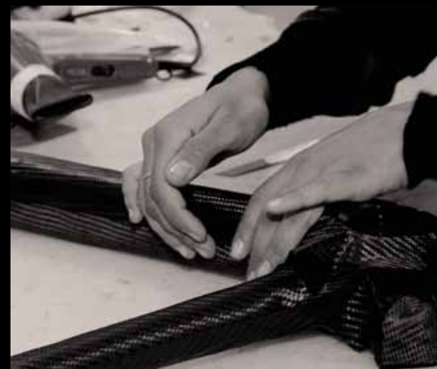
Composé de 430 pièces de carbone, Il faut une trentaine d'heures pour fabriquer le cadre 695.
