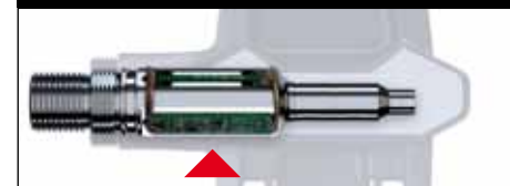
8 jauges de contrainte par axe permettent une mesure de la force avec une précision <2%
