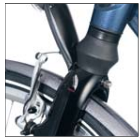
Carbon voorvork met luchtvering: extra rijcomfort
