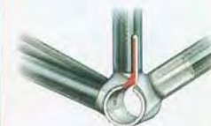
TRETLAGER: Das einzigartig geschmiedete Design bietet einen größeren Radius für jede Muffe und verstärkt die Rippen in den kritischen Punkten für einen größeren Oberflächenbereich. Diese Kriterien ergeben zusammen mit der harten Anodisierung zur Haltbarkeit, zusätzliche Kraft und Steifigkeit für eine bessere Kraftübertragung und eine höhere Seitensteifigkeit im Tretlager.
