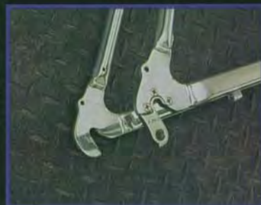
ZWEIFACH KONIFIZIERTE HAUPTTROHRE
