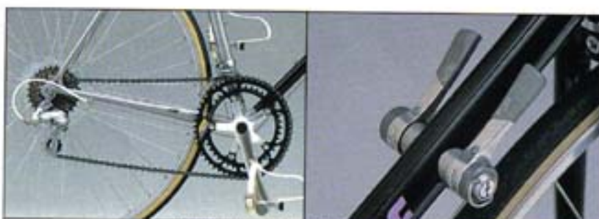
SHIMANO EXAGE-Action SIS derailleur, shifter
