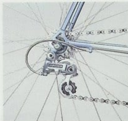
Shimano New Dura-Ace EX rear derailleur and freewheel.
