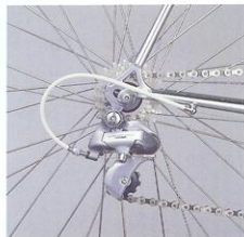
Shimano 600 Ultegra S.I.S. Hinterer Umwerfer mit 7-facher Übersetzung
