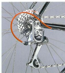
Shimano Deore XT II S.I.S. Hinterer Umwerfer und 7-Gang 13-30T HYPERGLIDE Kassette
