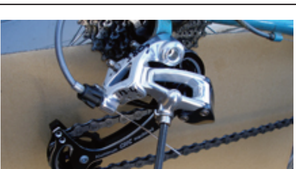
4. Loosen the cable pinch bolt.
