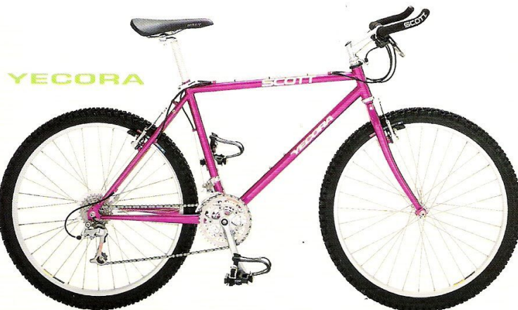
Tange Chromoly Double Butted Rahmen, Chromoly Tapered Gabel, Scott AT-2 New Multipositions Lenker Shimano STX RC 21 Gang mit Rapidfire Plus Schalthebel, Mavic 236 Hohlkammerfelgen, Tioga "Psycho" Reifen
