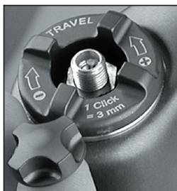
Fig. 2 TALAS Air Top Cap Knob & Schrader Valve
