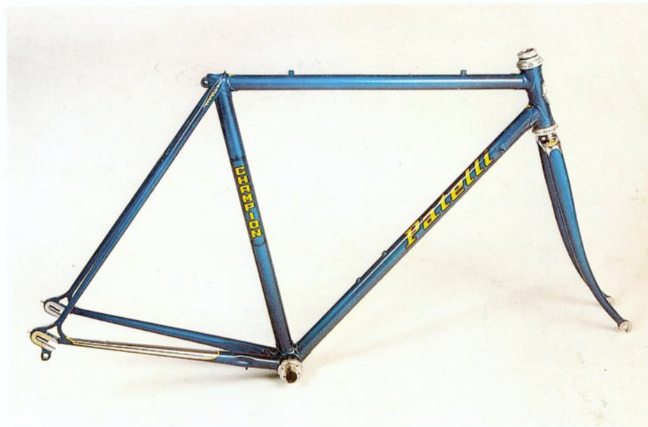
ART. T.10 - Con incisioni normali Telaio S.L. Columbus - Scatola movimento e testa forcella microfusione con attacco deragliatore saldato - Sterzo a movimento Campagnolo - Verniciato e cromato
