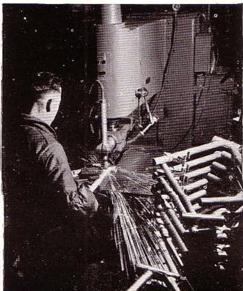
SOUDURE ÉLECTRIQUE DES RENFORTS DE CADRES.
