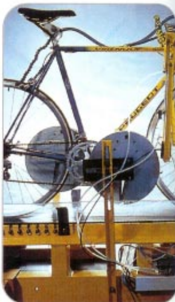
Test de freinage au banc d'essai. Fatigue test on a test bench.
